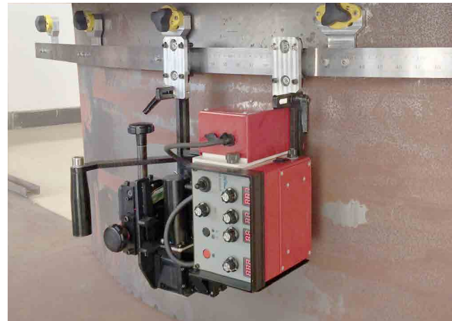
Traktor auf Stahlschiene im Einsatz
