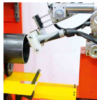
Auch zum Schweißen im Rohrinnein geeignet
