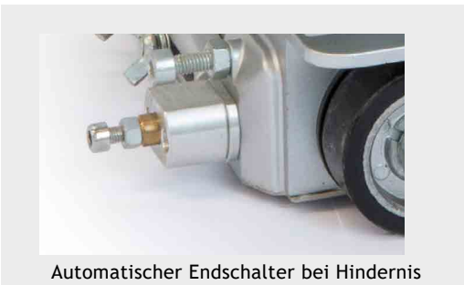
Automatischer Endschalter bei Hindernis
