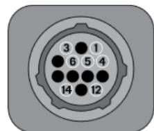
CNC-Schnittstellenanschluss auf der Rückseite der Stromquelle
