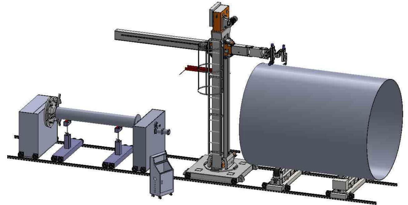
Manipulator mit zwei Aktionsseiten zur Rohrbearbeitung auf Drehtisch oder Rollenbock mit
