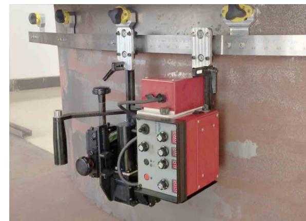
Traktor auf Stahlschiene im Einsatz
