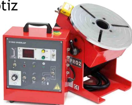
Schweißdrehtische im Baukastensystem
