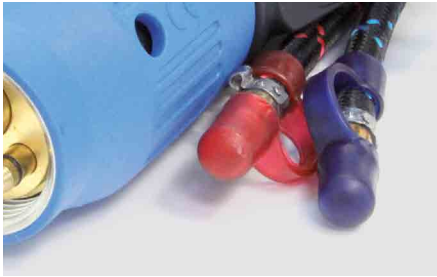
Schutzkappen auf Wasserschläuchen.
