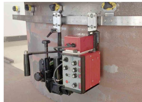
Traktor auf Stahlschiene im Einsatz
