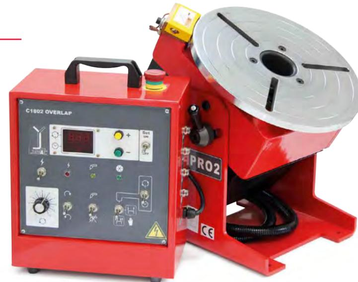
**DAS GEHÄUSE DES DREHTISCHES MUSS MIT DER HAUSERUNG DIREKT VERBUNDEN WERDEN!**
