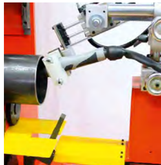
Auch zum Schweißen im Rohrinnebau geeignet
