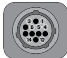
CNC-Schnittstellenanschluss auf der Rückseite der Stromquelle
