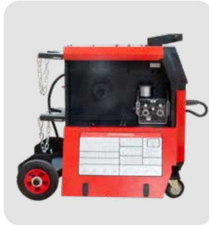
Drahtaufnahme für Spulen bis 15 kg
