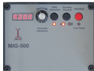
Bedienfelder der MIG-500 und MIG-502 Traktoren
