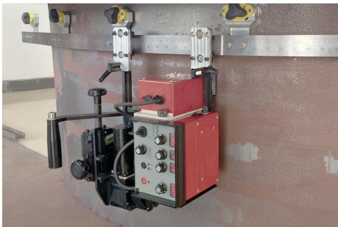
Traktor auf Stahlschiene im Einsatz
